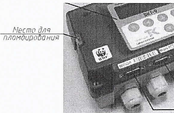
Схема пломбирования тепловычислителя
