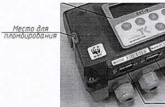
Схема пломбирования тепловычислителя
