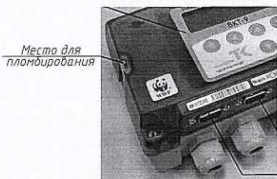
Схема пломбирования тепловычислителя
